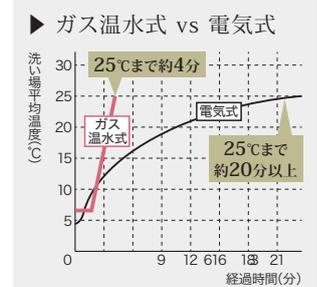
○ガス温水式:3.3kW ○電気式:1.4kW ○試験条件/浴室:1坪用ユニットバス 環境:外気温5℃、湿度65%
