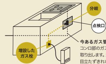
今あるガス管(床下)コンロ部のガス管から取り出します。ガス栓が目立たずきれいです。
