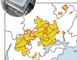
ガス供給停止地区を最小限に抑えるため、現在、地区ガバナからお客さままでの低圧導管網を18のブロックに分割。また地震直後に被災状況を判断するために各ブロックには地震計を設置しています。
